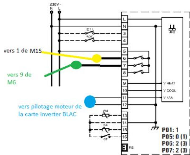
Fig. 8: Schema di collegamento per pilotaggio di due attuatori on/off a 230V ~ per impianto a 4 tubi e pilotaggio proporzionale del ventilatore.
